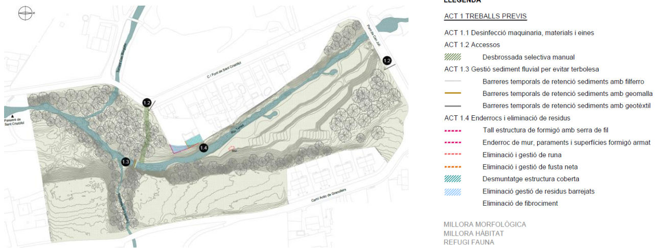
Figura 5. Planta propuesta. Trabajos previos
