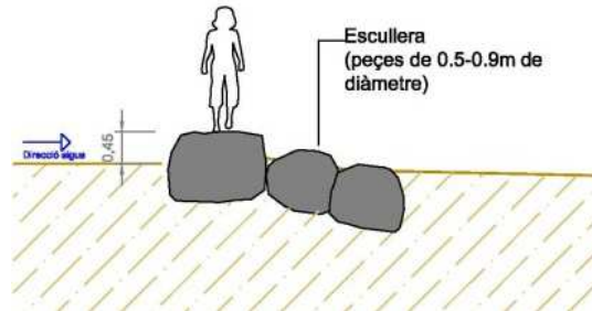
Corte transversal del paso en piedra (ejemplo)
