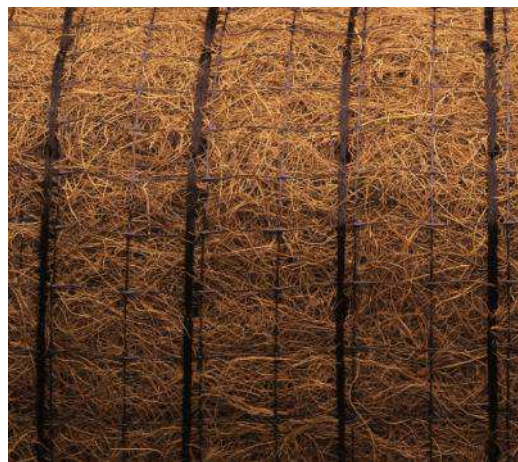
Manta orgànica de fibra de coco lligada amb fil de polipropilè fotodegradable.
