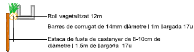
Imatge 8 // Esquema de l'integració del canal de regants.
