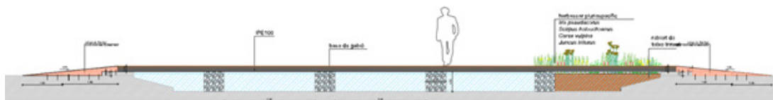
Secció d'una passera que travessa el llac
