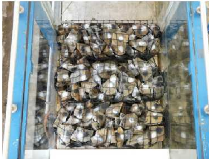
Figura 4. Marcat de la grava superior del cilindre
