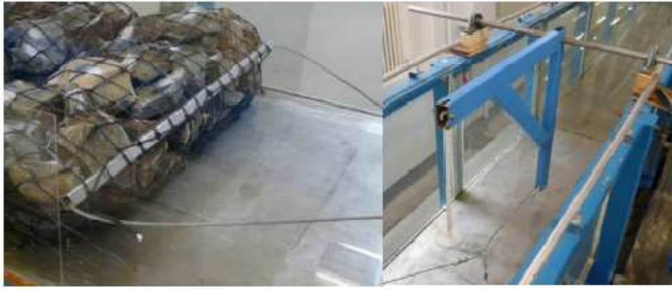
Figura 5. Sistema per a aplicar la tensió
